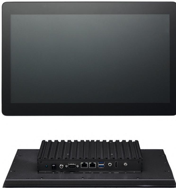
Промышленный многофункциональный панельный компьютер ПМПК-16-100-08-120 предназначен для монтажа на панель или на крепление по стандарту VESA. ПМПК-16-100-08-120 имеет сенсорный емкостный дисплей с высоким разрешением. Защита лицевой панели по стандарту IP65 и отсутствие вентиляторного охлаждения позволяет применять его в агрессивной окружающей среде.
