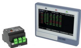
**МАЯК ПК-4007.** Панельный компьютер (сенсорный дисплей 7", Ethernet, RS-485, USB, MicroSD).
