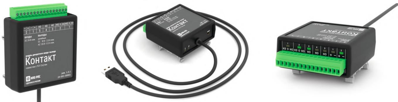
Модуль дискретного ввода и релейного вывода МДВВ Контакт предназначен для ввода дискретных данных и программируемой релейной коммутации при подключении источников бесперебойного питания в системы телесигнализации/телеуправления. Все входные и выходные каналы независимы и гальванически развязаны. Имеет возможность крепления на DIN рейку. Предназначен для совместного использования с платами сетевого управления ПСУ Спутник (подключается по USB).
