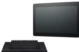
**ПМПК 16-100-08-120.** Промышленный многофункциональный панельный компьютер (сенсорный дисплей 15.6 дюйма, Ethernet, защита лицевой панели IP65, Intel® Celeron® processor J3455, Quad Core, 1.50 GHz, 8GB RAM, 120GB SSD).
