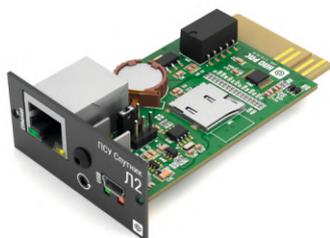
**Базовая модель компактного исполнения для однофазных ИБП**
